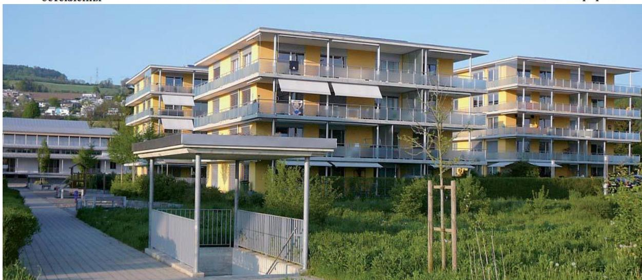
В этом жилом комплексе есть много элементов, которые очень удачны с точки зрения защиты птиц. Стеклопакеты полупрозрачны, а многие жильцы устанавливают в верхней части своих балконов дополнительные непрозрачные защитные экраны.
