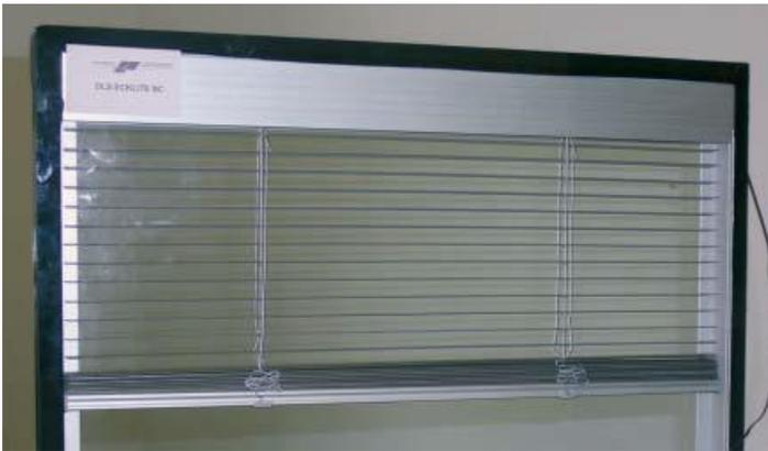
Внутренние жалюзи. Даже когда они не закрыты полностью, вид поперечно расположенных полос в определенной степени защищает птиц от столкновений с окнами.
