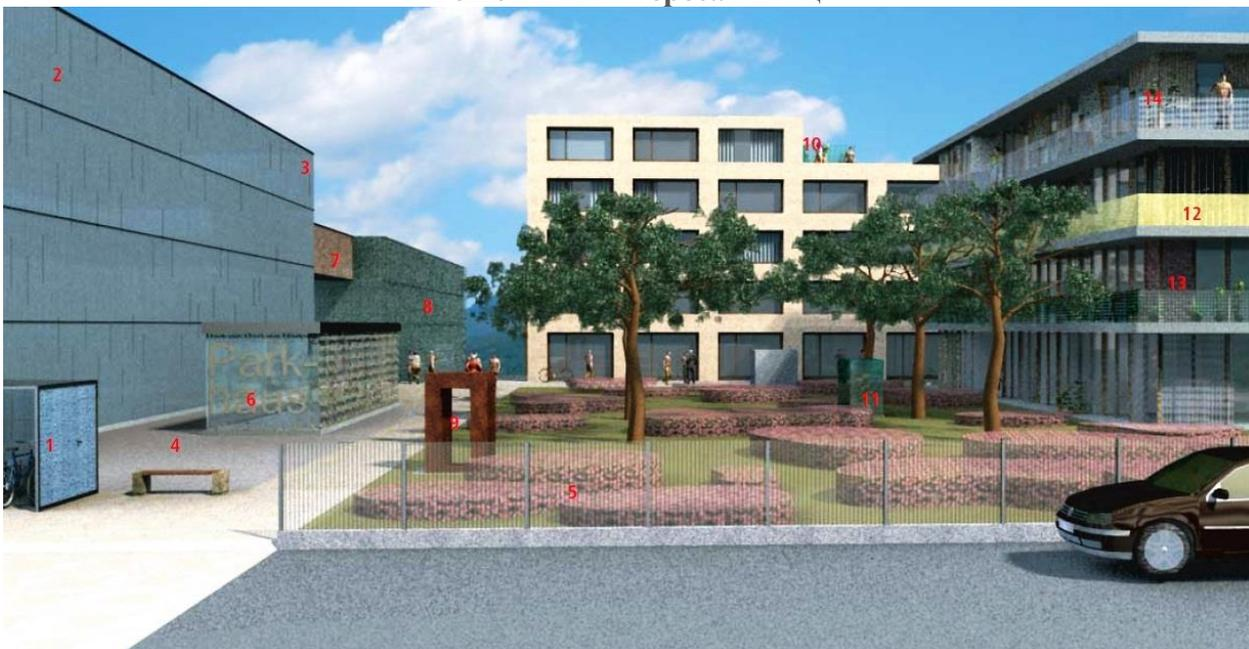
Визуализация показывает, с помощью каких средств можно избежать «птичьих ловушек» в современной застройке (см. стр. 8): 1 – навес для велосипедов из полупрозрачного материала, 2 – стекла с высокоэффективной маркировкой, 3 – углы здания не должны содержать прозрачных элементов, 4 – адаптированное с учётом восприятия птиц окружающее пространство (отсутствие зеленых зон, привлекательных для птиц, и
