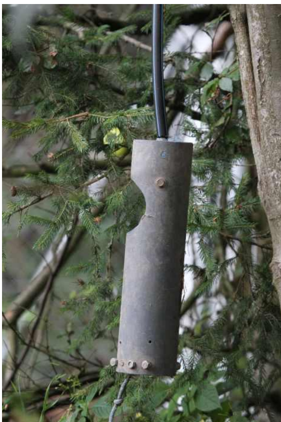
Иллюстрация 44: подробное изображение конструкции. Пластиковая водопроводная труба закреплена поверх верёвки в целях безопасности. Фото: Кнёпфер
